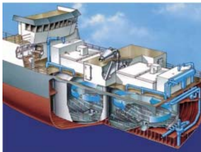
Bombeo por vacío y almacenamiento de pescado en tanques RSW
