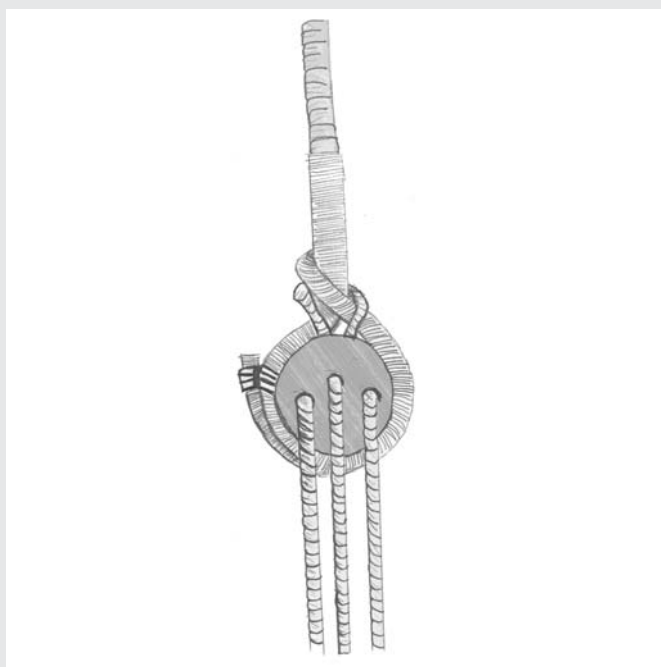
Detalle de la implicación del cambio de menas en la jarcia del buque (vigotas, obenques y acolladores)
