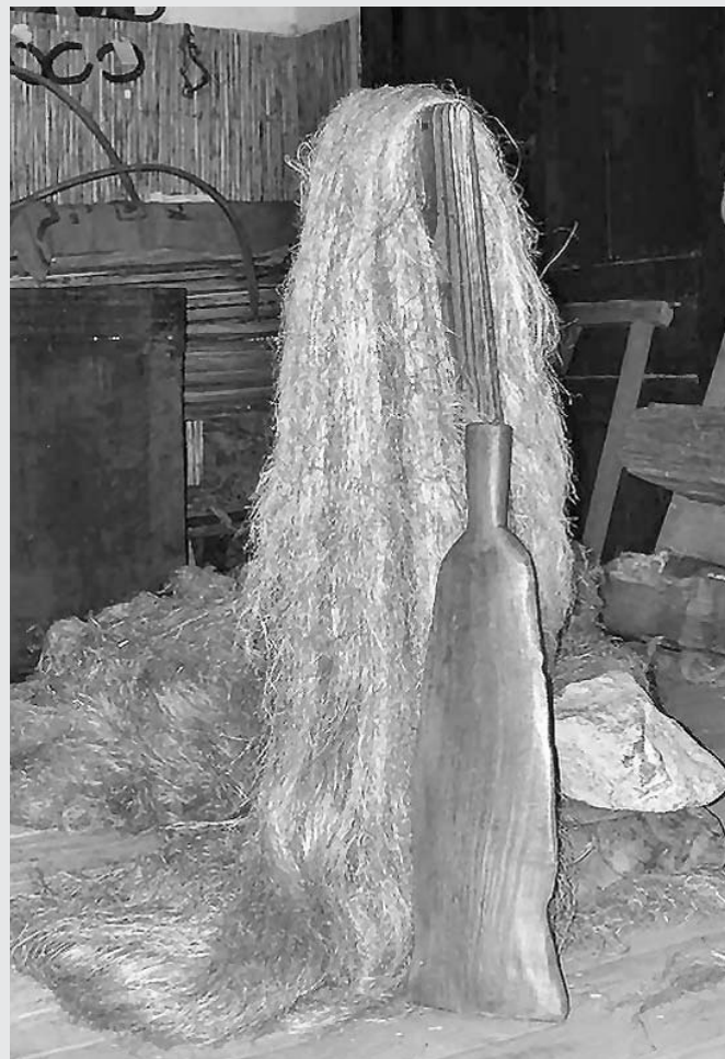
Vista del espadador (tabla fijada al suelo) y de la espadilla (utensilio de golpeo). Museo del Cáñamo de Callosa de Segura - Archivo fotográfico CEFIRE - Elda
