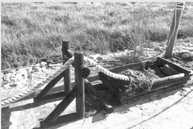
Peso en el extremo para el corchado de la jarcia s.XVI. Muelle de las Carabelas/La Rábida
